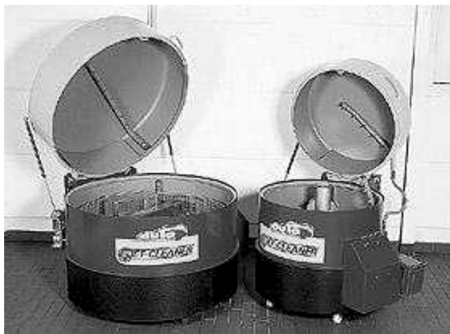
Abb. 3: KW-Substitution durch wäßrige Reinigungsautomaten: Hier autop Jet-Cleaner 82 t und 122 t.
